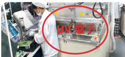
改善方案 UV 爐紫外線消毒代替人工酒精擦拭
